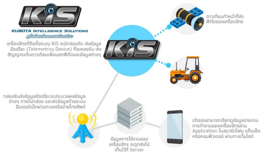
ภาพที่ 5 การทำงานเครื่องจักรกลเกษตรอัจฉริยะของคูโบต้า
